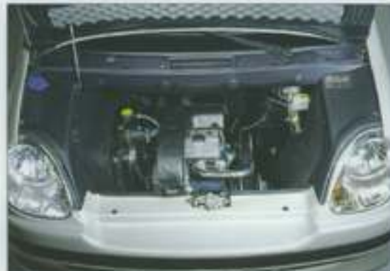
Le moteur KUBOTA spécifique AIXAM et son insonorisation. • Ce moteur a encore progressé en souplesse et en niveau de bruit. • Sa suspension est étudiée pour limiter les vibrations.
