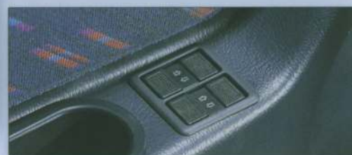
Commande de vitres électriques.
